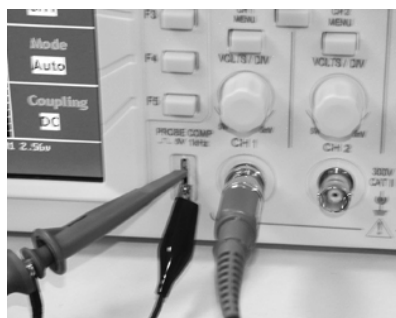
Рис. 5.1.1.1. Компенсация пробника
