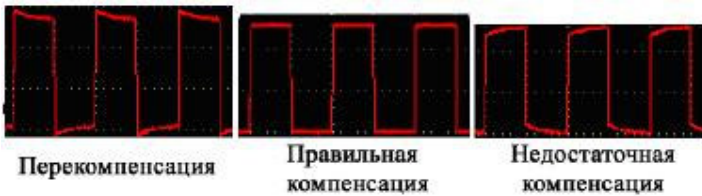
Рис. 5.2.1 Отображаемые осциллограммы компенсации пробника
