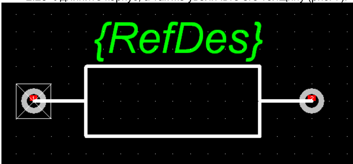
Рис. 7 Корпус резистора мощностью 1Вт ( Grid=1.25mm )
