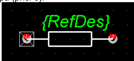
Рис. 6 Корпус резистора мощностью 0,5Вт ( Grid=1.25mm )
