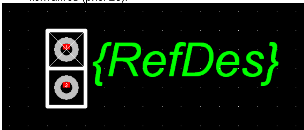
Рис. 26 Посадочное место разъема PLS2 (Grid=1.25mm)
