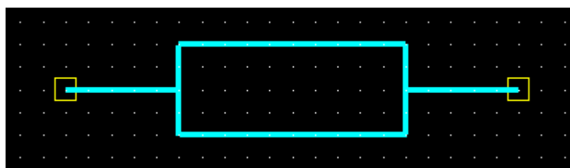
Рис. 5 УГО резистора ( Grid=1mm )
